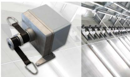
Les moteurs EGM sont spécialement conçus pour la régulation des systèmes d'admission d'air dans les exploitations d'élevage intensif. L'EGM est équipé d'un robuste moteur sans balais de 24 volts avec une force de traction de 100 respectivement 250 kilos. La série EGM est fournie de façon standard avec un tambour d'enroulement et est livrable avec un signal de commande 0-10 V ou un retour de potentiomètre.
