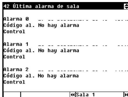
Para cada sala se guardan las cinco últimas causas de alarma que hicieron que el relé saltase por haber condiciones de alarma en la sala correspondiente. Se muestra la causa de la alarma, además de la fecha y la hora.
