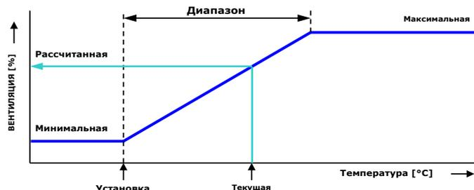
Группы вентиляторов «**Левая/правая/передняя/центральная/задняя рециркуляционная/верхняя и нижняя**» идентичны установкам и настроены на одинаковые значения. Группа вентиляторов может состоять максимум из 3 отдельных регуляторов (заслонок). Установка температуры, пропускная способность и минимальное и максимальное значения вентиляции применяются ко всем трем регуляторам (1, 2 и 3).
