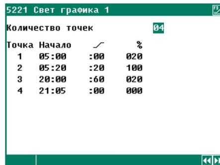
Вы можете установить максимум 9 разных графиков освещения. Каждый график освещения может состоять максимум из 48 периодов.
