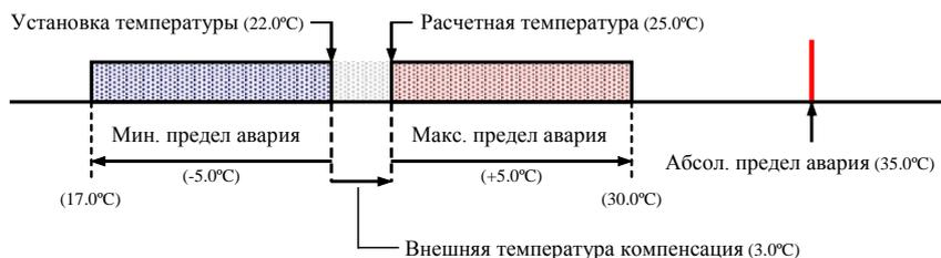
3. Максимальный предел срабатывания аварийной сигнализации превышает абсолютный:
